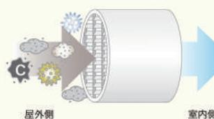
縦方向に帯電させた繊維をセットし、空気を通過させて磁力でゴミや煤じんを捕集するシステムなので、空気の流れを塞がず、長期間フィルターの使用が可能です。
