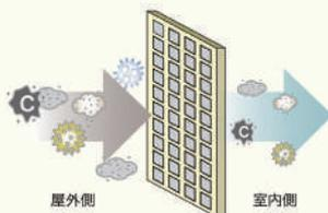
フィルターの目詰まりを応用して捕集するシステムなので、フィルターの目が塞がってしまうと空気が流れなくなり、捕じん率も低下。頻繁なフィルター交換が必要です。
