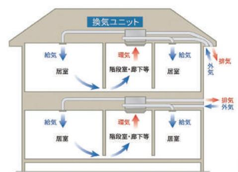
エアコンもセットになって、全部屋冷暖房と24時間換気ができる顕熱タイプの空調併用換気システムです。
